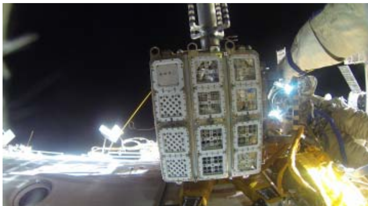
Фиг. 5 В центъра е платформата EXPOSE-R2. Приборът R3DR2 е в нейния горен десен ъгъл. В долната част е модулет „Звезда“ на МКС. В горния десен ъгъл се вижда ръката на космонавта Г. Падалка, а в заден план е космонавта М. Корниенко. (Фотографията е направена на 10 август 2015 г. благодарение на ЕКА и РОСКОСМОС.)
